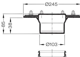
**Aufsatzelement mit Muffe**
